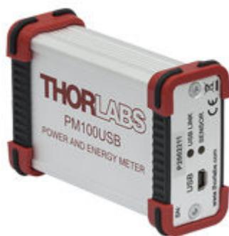
**Figura 3.2** - Interface ótica entre o computador e o sensor ótico. Possui conexão USB e permite medir a faixa de 185nm a 2500nm com potência de 100pW a 200W.
