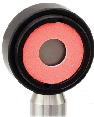
**Figura 3.3** – Detector ótico modelo S120C que possibilita medir a luz no comprimento de onda na faixa de 400nm a 1100nm com potência de 50nW a 50mW.
