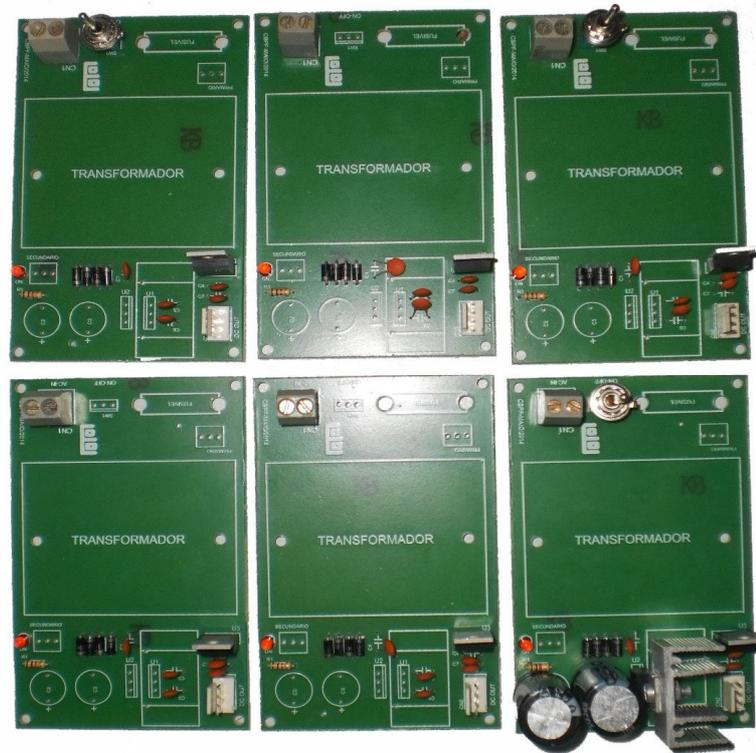
Figura 4.4 - Em (a) as 6 placas da fonte de corrente montadas e em (b) as 6 fontes de tensão.
