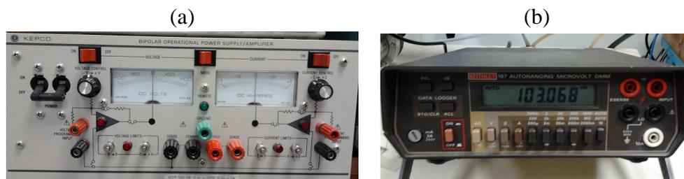
Figura 2.37: Fonte DC e multímetro
