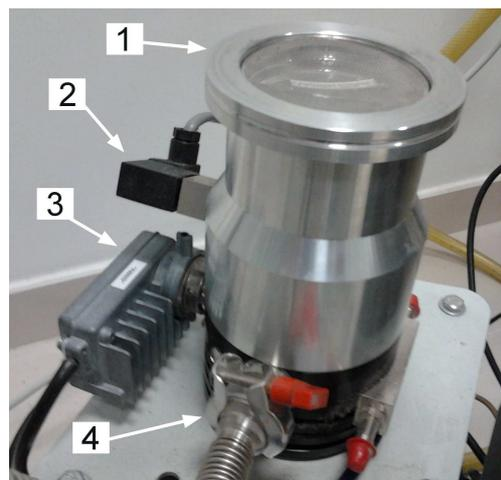
1- Conexão para a câmara de vácuo; Válvula para vazamento (*vent valve*); 3- Conexão elétrica; 4- Conexão para BM.
