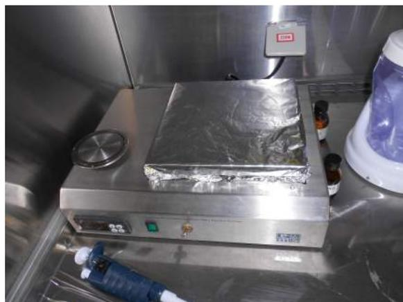
Figura 4.3: Placa Aquecedora do LABNANO - CBPF.
