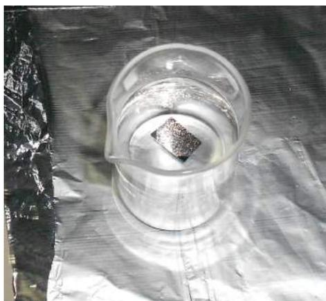
Figura 4.9: Foto de um processo de *Lift-Off*.
