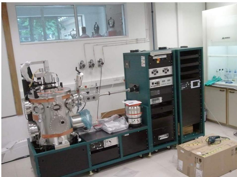
Figura 4.7: *Sputtering* AJA do Laboratório de Superfícies e Nanoestruturas do CBPF.
