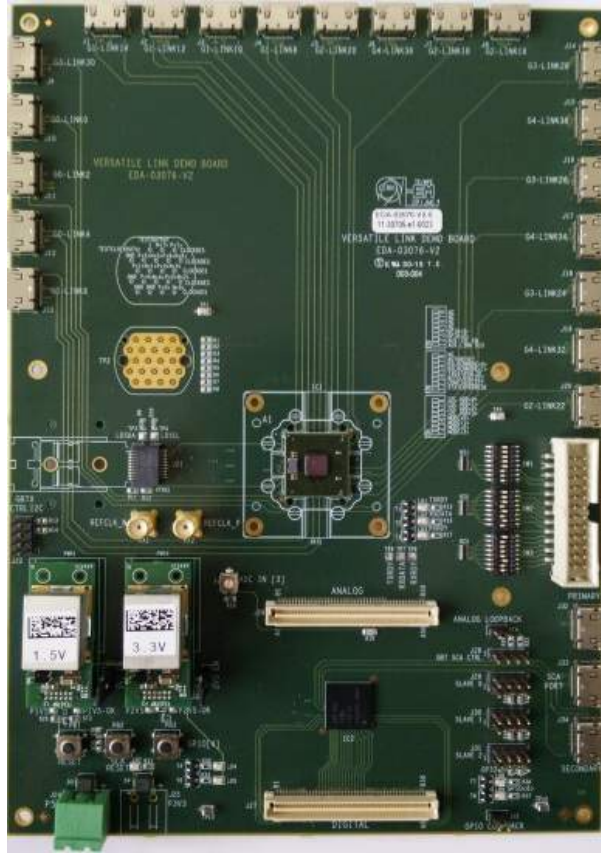
Figura 9.4: Vista superior da placa VLDB.
