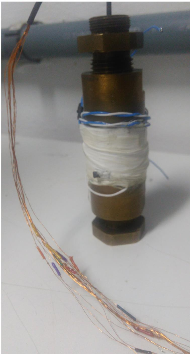
Figura 42 – Montagem completa da célula de pressão de 25 kbar.
