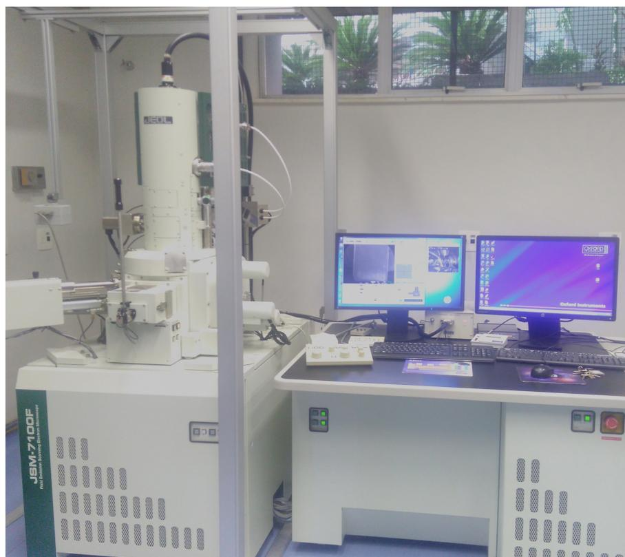
Figura 36 – MEV modelo JSM-7100V, LabNano - CBPF
