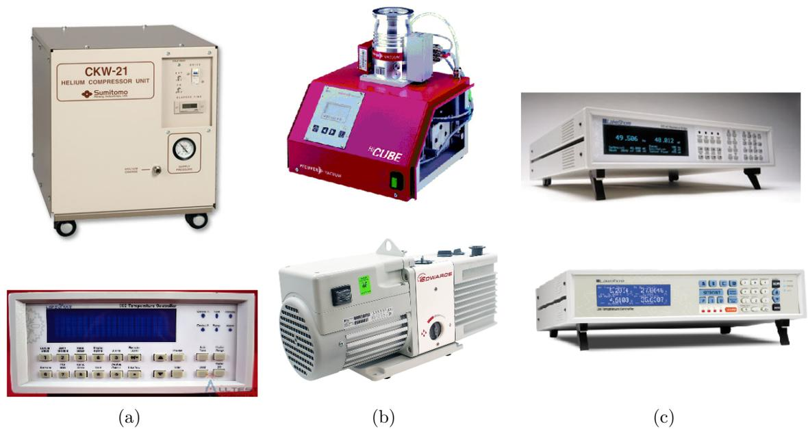
Figura 44 – (a) Compressor Sumitomo CKW-21 (acima), usado para reduzir a temperatura do sistema e o controlador 332 (abaixo). (b) Bomba de vácuo turbo-molecular HiCube (acima) para o vácuo de isolamento e Bomba de vácuo mecânica Edwards (abaixo) para a purga do hélio da câmara de amostras. (c) Lakeshore 370 AC (acima) para medida de resistência elétrica e Lakeshore 336 (abaixo) para o controle de temperatura.
