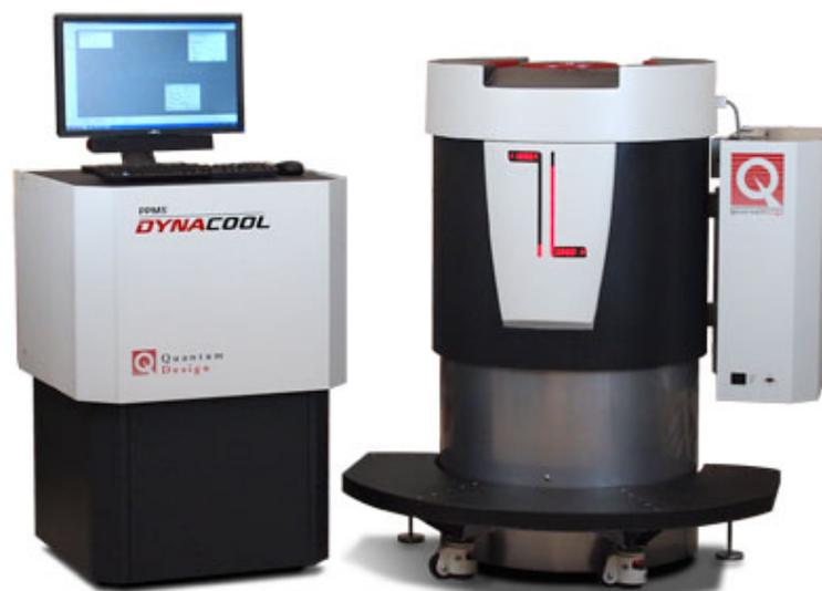
Figura 45 – PPMS Dynacool, realiza medidas de magnetização e calor específico.
