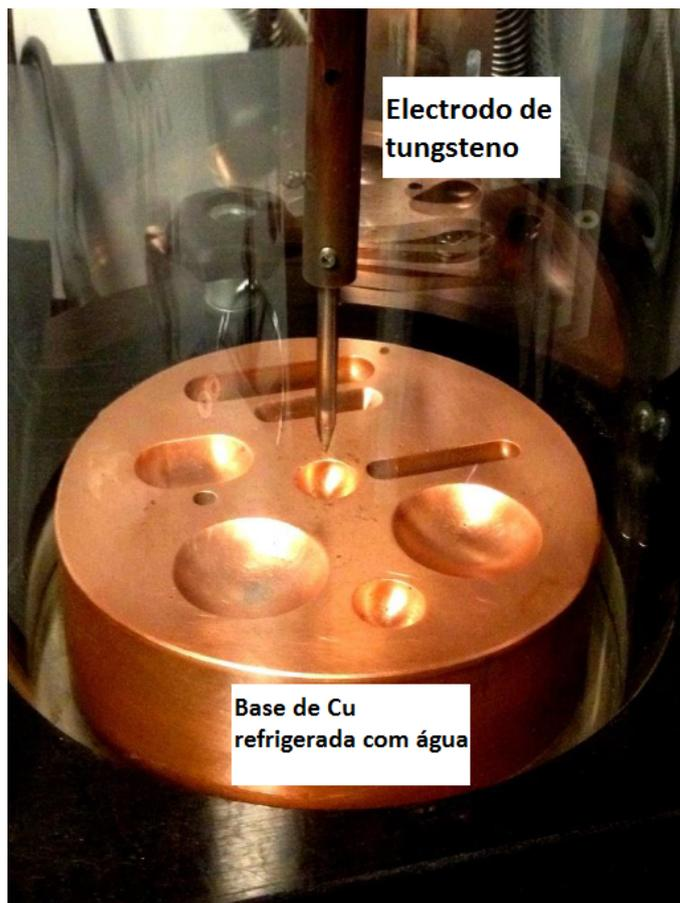
Figura 35 – Vista do forno a arco utilizado para preparar amostra de  $Sc_{3,1}In$  [5].
