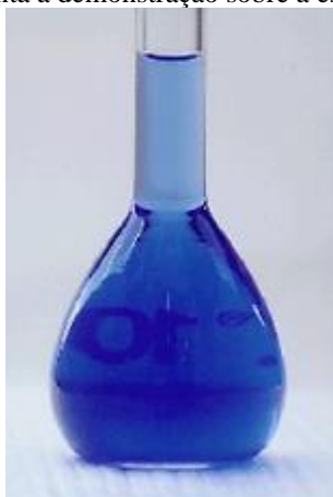
Figura 5 - Solução de \text{CuSO}_4 que apresenta a demonstração sobre a espessura da camada do corpo homogêneo.
