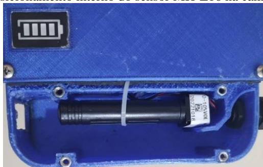
Figura 50 - Posicionamento interno do sensor MH-Z16 na câmara de medição.
