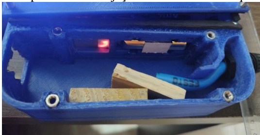
Figura 49 - Experimento de injeção direta do ar do tanque no sensor.
