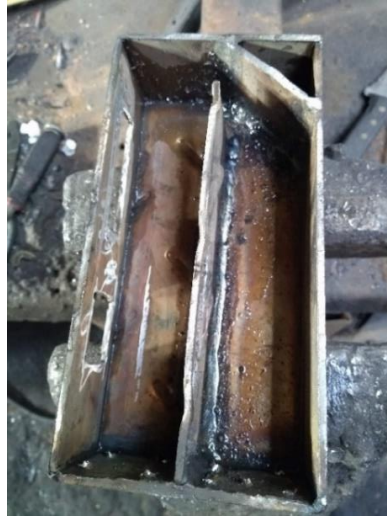
Figura 38 - Detalhe interno da câmara de inox de separação de líquido e gás.
