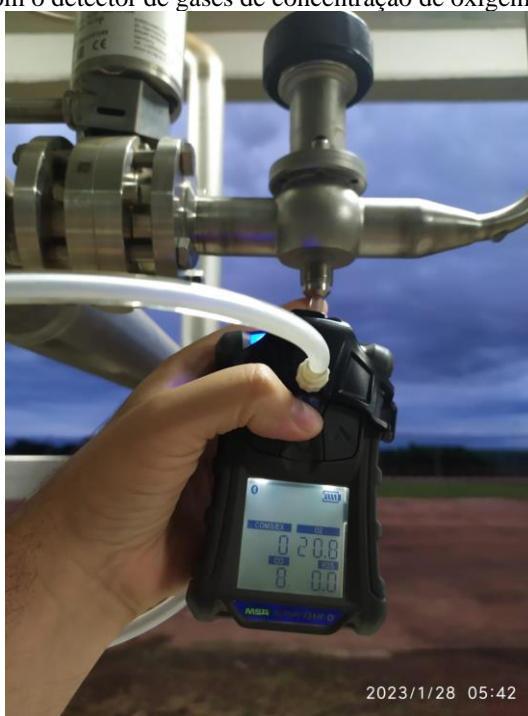
Figura 46 - Experimento com o detector de gases de concentração de oxigênio para liberação da assepsia.
