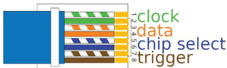
Figura 3.8: Ordem de crimpagem do cabo para utilização na comunicação LVDS.
