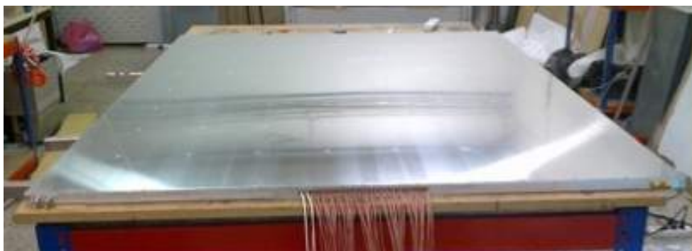
Figura 3.5: Foto de uma RPC montada, com os cabos coaxiais, conectores para gás e HV à mostra. A pad 1 nesta RPC é a mais próxima da quina frontal esquerda.
