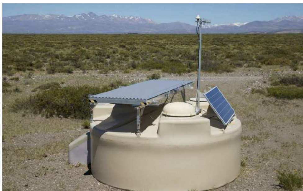
Figura 2.16: Foto de um WCD, com um SSD instalado, no array do SD. Retirado de [22]
