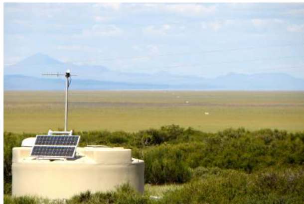
Figura 1.9: Foto de uma estação de detector de superfície, sendo visível ao fundo outras estações do array
