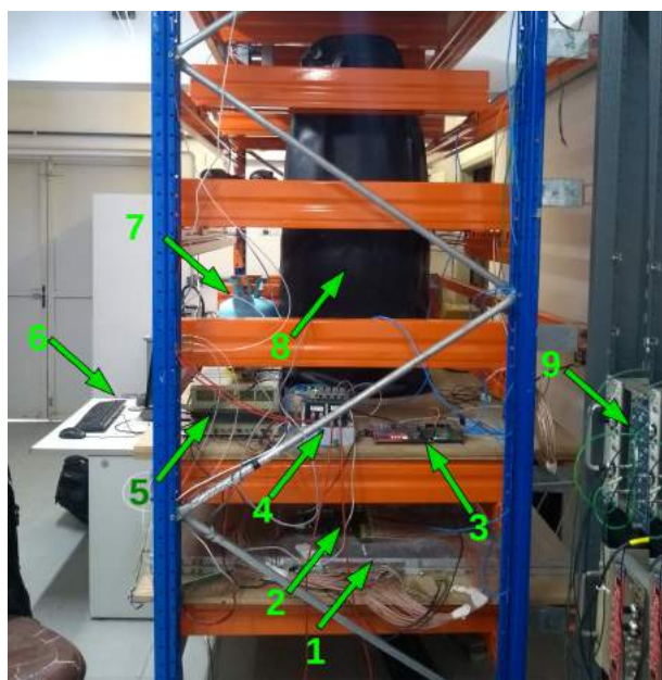
Figura 3.22: Hodoscópio instalado no CBPF. 1: RPC inferior; 2: Front-End e Mezzanine ; 3: CeU e Interface ; 4: Sistema de monitoramento e alta tensão; 5: Fonte de alimentação geral; 6: Estação local de programação e debugging; 7: Cilindro de gás R143a; 8: WCD; 9: Crate NIM onde está a fonte de alta tensão da PMT do WCD. O Osciloscópio, assim como a RPC superior, estão fora do enquadramento da foto.
