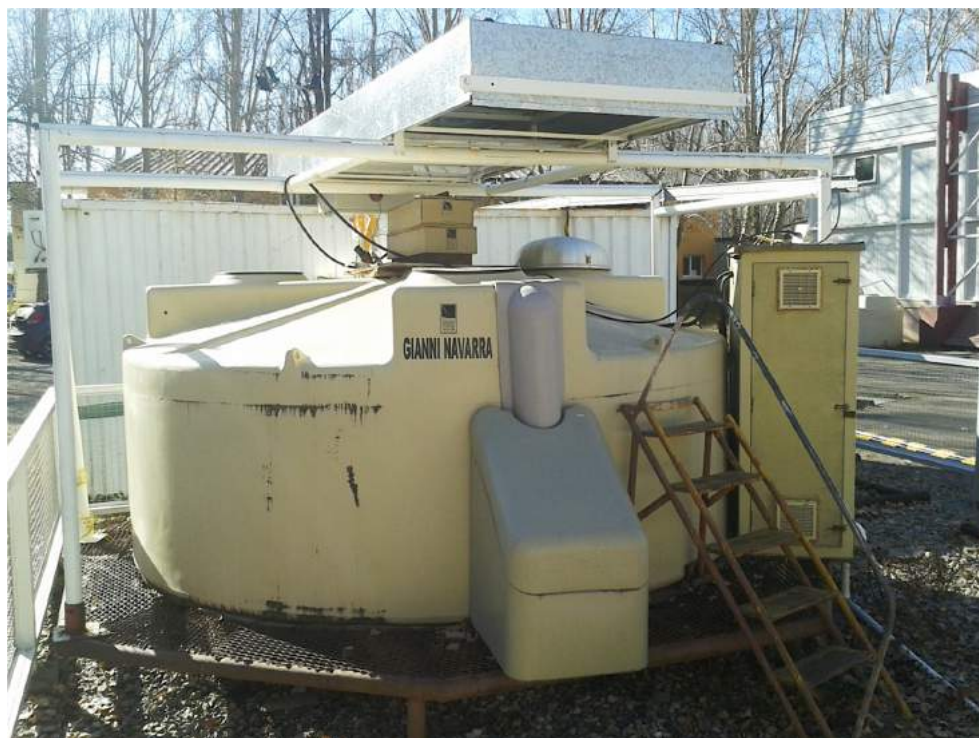
Figura 1.16: Foto da estrutura na estação experimental do WCD Gianni Navarra. A caixa metálica vista acima do WCD abriga a RPC superior, enquanto a RPC inferior fica em um trilho abaixo da estrutura.
