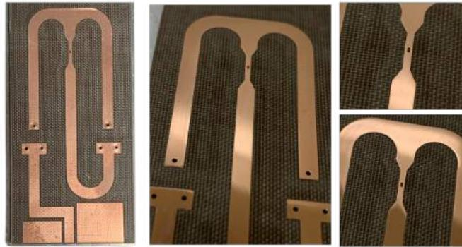
Figura 3.11: Ressonador antes do polimento à esquerda. Ao centro e à direita, vemos o ressonador polido. Imagem produzida no CBPF.
