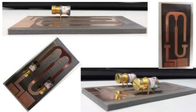
Figura 3.12: Microressoador planar fabricado para operar em alto campo, sintonizado em 500MHz
