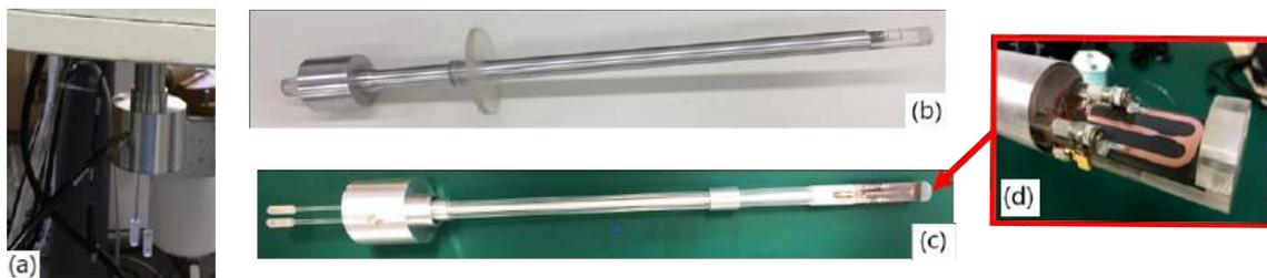
Figura 3.17: Sonda de alto campo fabricada: (a) Sonda conectada ao espectrômetro de alto campo; (b) Corpo da sonda de inserção, vista externa; (c) Corpo da sonda de inserção, vista interna; (d) Destaque para o microressonador planar.
