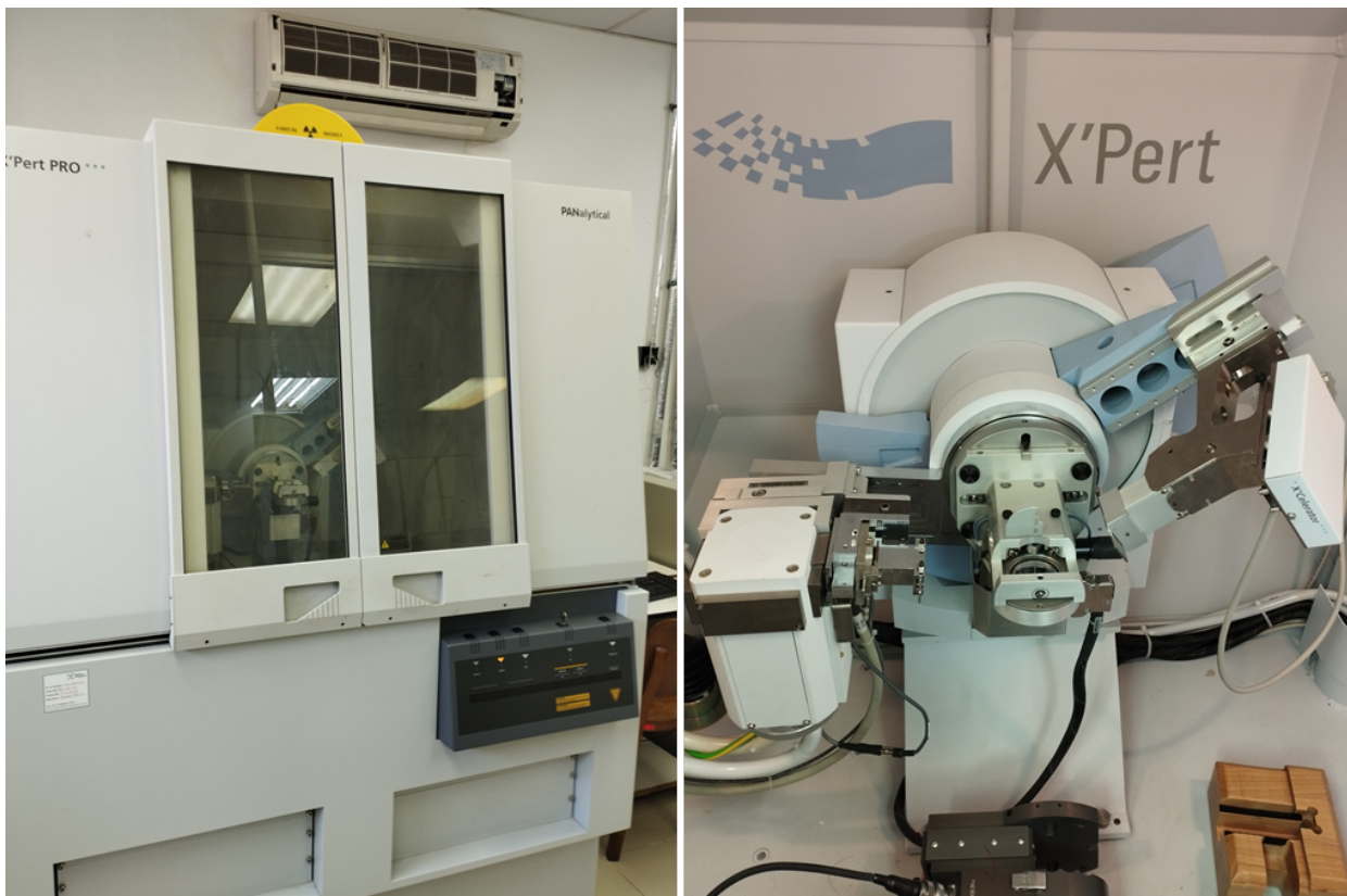
Figura 27 – Difratorômetro X'Pert PRO (Philips Panalytical) utilizado para determinação da fase cristalina do composto utilizando os princípios da lei de Bragg.
