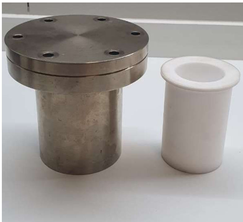
Figura I.1: Reator hidrotérmico composto por um copo de aço inox e um copo de teflon com capacidade de 100 ml.
