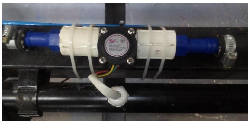
FIGURA 33 – Sensor YF-S201 instalado.
