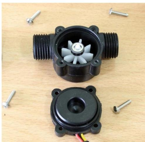
FIGURA 31 – Interior do sensor de vazão YF-S201.
