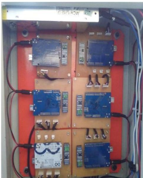
FIGURA 67 – Acomodação dos Arduinos Uno dentro do painel.
