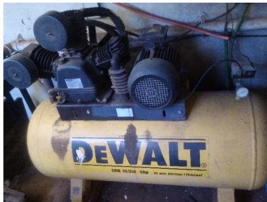
FIGURA 44 – Compressor elétrico de pistão.
