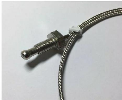
FIGURA 9 – Sonda do termopar K utilizado.
