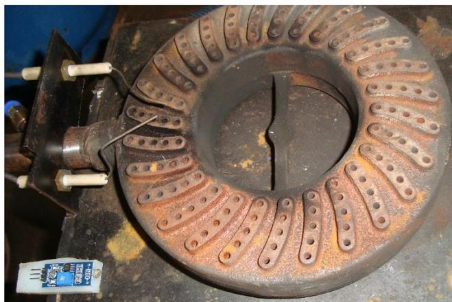
FIGURA 39 – Módulo LDR instalado próximo ao queimador.
