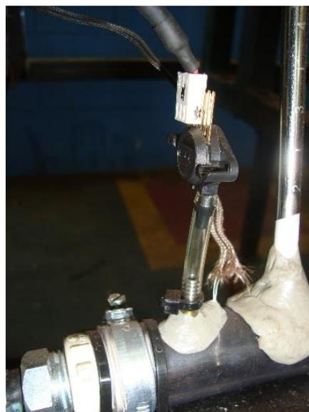
FIGURA 22 – Sensor MPX5700AP instalado.
