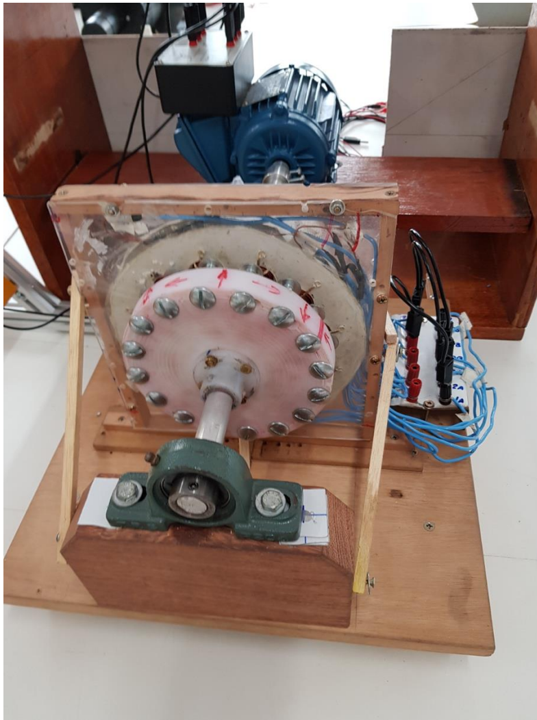
Figura 18 – Montagem do Gerador
