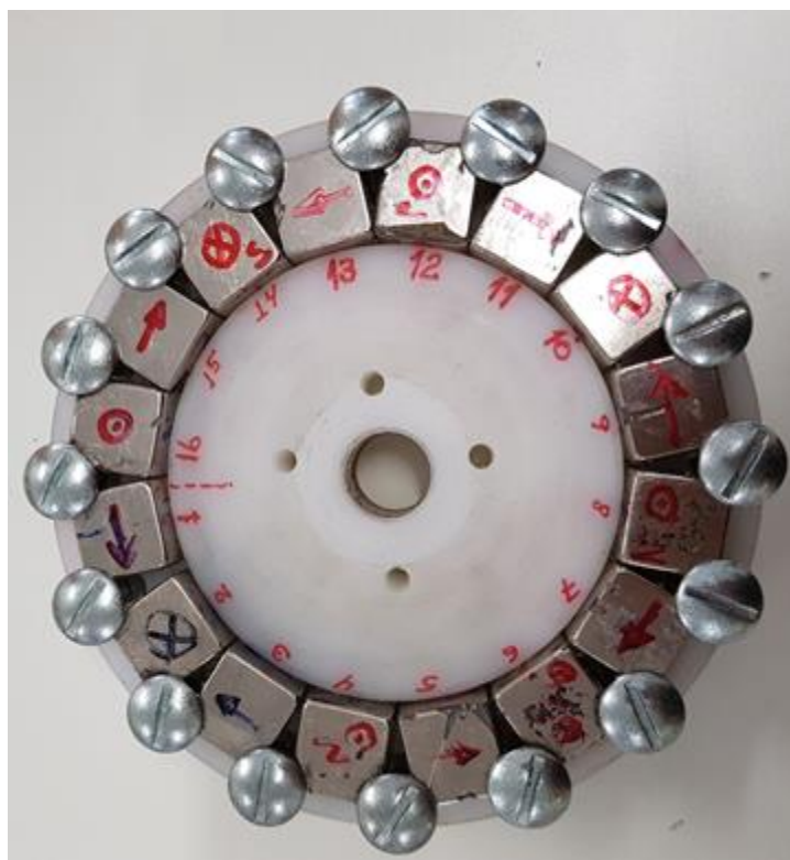
Figura 5 – Rotor com arranjo Halbach.
