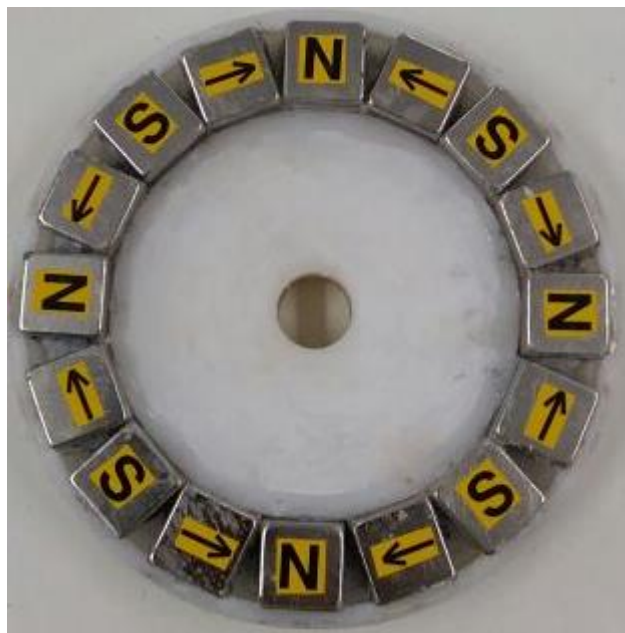
Figura 10 – Rotor finalizado com a indicação dos sentidos dos campos magnéticos
