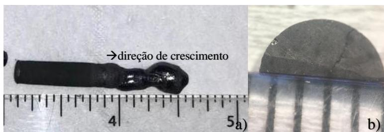
Figura 4.1: a) Cristal de LCMO sintetizado pela técnica da zona flutuante. b) Região monocristalina cortada.
