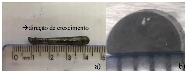
Figura 4.3: a) Cristal de LSCMO sintetizado pela técnica da zona flutuante. b) Região monocristalina cortada.
