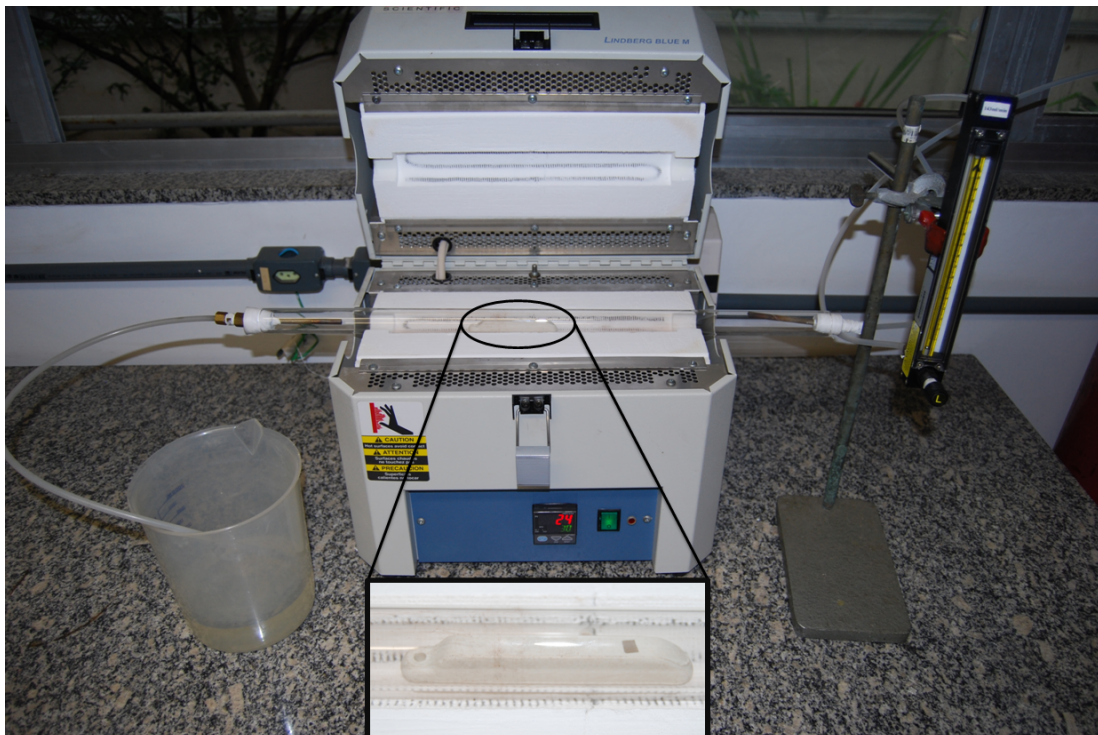
Figura 4.3: Sistema de tratamento térmico de amostras de YIG, com atmosfera controlada.
