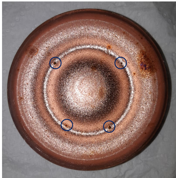
Figura 5.19: Alvo de cobre dopado com esferas de bismuto. As esferas de bismuto estão circuladas em azul para facilitar a visualização
