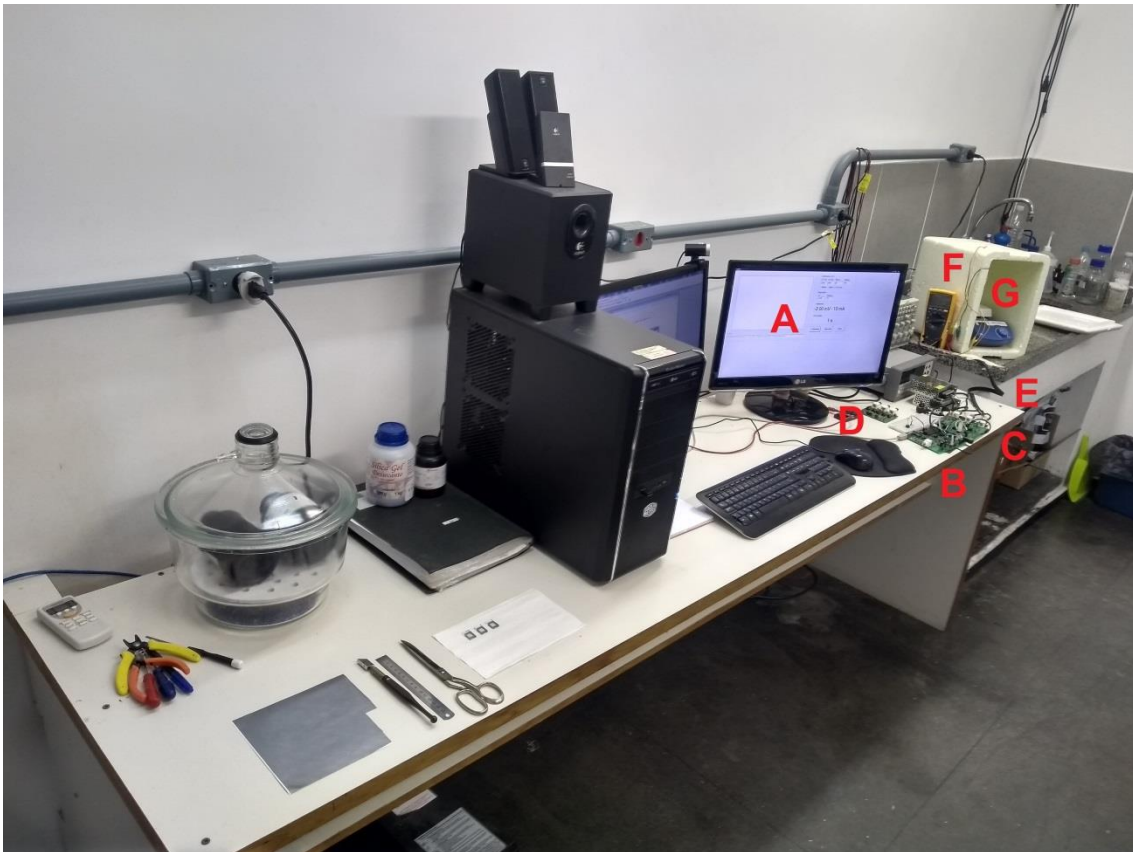
Figura 19 – Bancada completa do sistema de eletrodeposição e potenciometria utilizado ao longo do trabalho no LEPS-CBPF composto pelo computador com o programa de controle instalado (A), as placas de controle e aquisição (B), do potenciostato (C) e de medida de pH (D), os cabos de conexão da célula eletroquímica (E), multímetro com termopar para controle de temperatura (F) e a caixa de isopor com a manta térmica (G).
