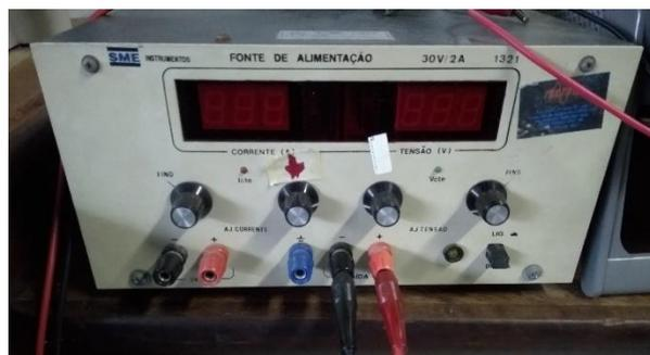
Figura 8: Fonte de alimentação com regulação de tensão.
