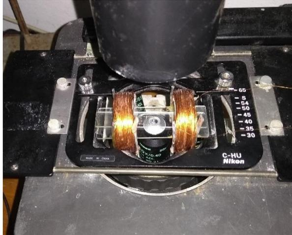
Figura 7: Bobina de Helmholtz acoplada à lâmina.
