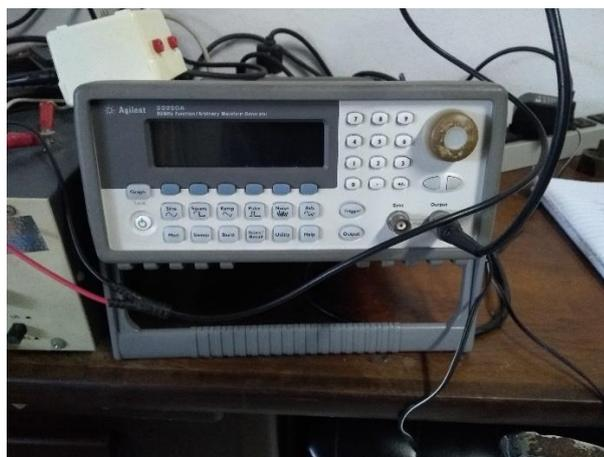
Figura 9: Gerador de funções para o campo magnético oscilante.
