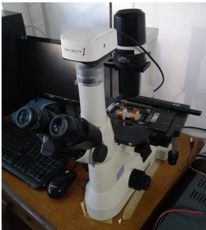
Figura 6: Microscópio óptico utilizado como sistema de observação.
