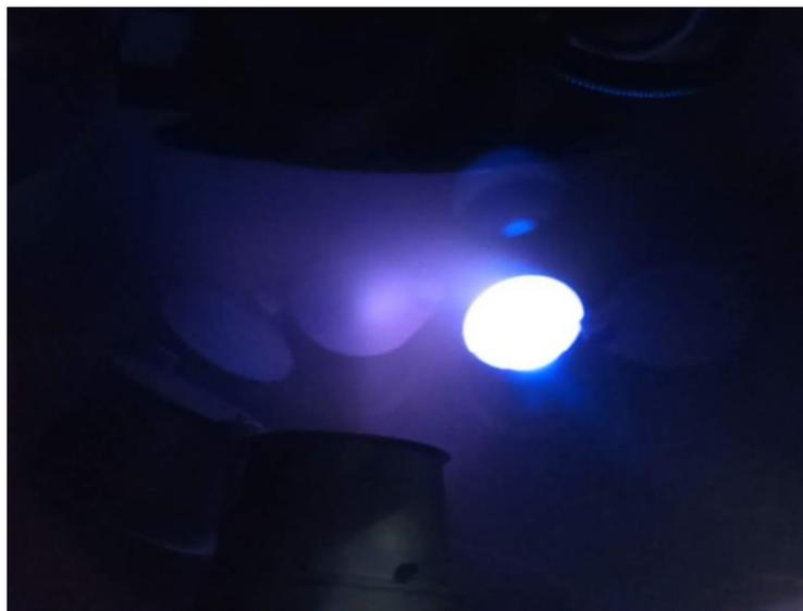
Figura 112 – Confinamento do plasma no campo magnético entre os magnetrons
