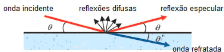
Figura 125 – Refração e reflexão na superfície de um material.
