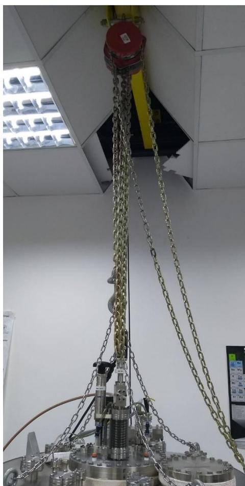
Figura 110 – Roldana instalada no teto para suspensão da tampa da câmara de vácuo
