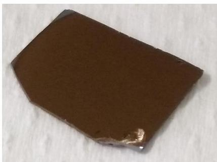
Figura 147 – Amostra TiN produzida com os melhores parâmetros de deposição, porém aquecida em 550°C.
