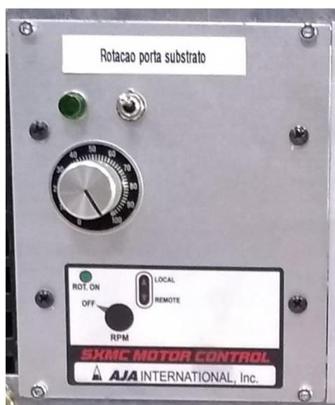
Figura 45 – Acionamento do motor do porta-amostra AJA SXMC.
