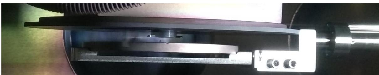
Figura 123 – Porta-amostra desalinhado em dois eixos
