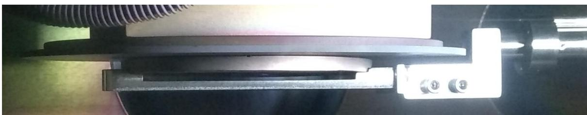
Figura 121 – Porta-amostra em posição de rotação para acoplamento
