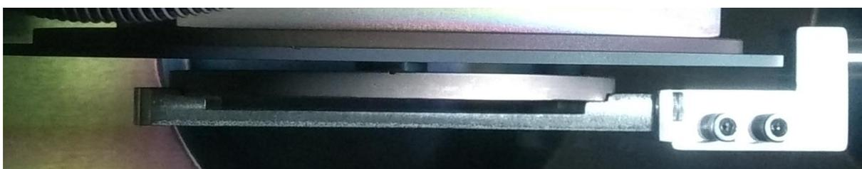
Figura 120 – Chanfro do porta-amostra corretamente inserido no eixo do motor
