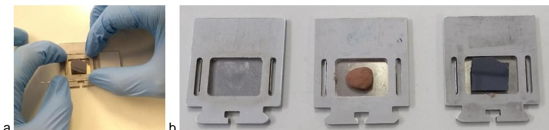
Figura 135 – a) alinhamento da amostra ao porta-amostra do difratômetro; b) porta-amostra, com a massa de modelar, e com a amostra posicionada.
