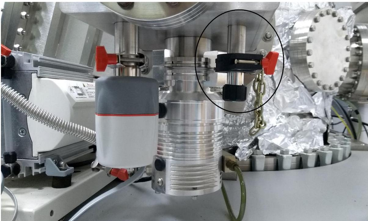
Figura 109 – Válvula para "quebra de vácuo" na *Load-Lock*
