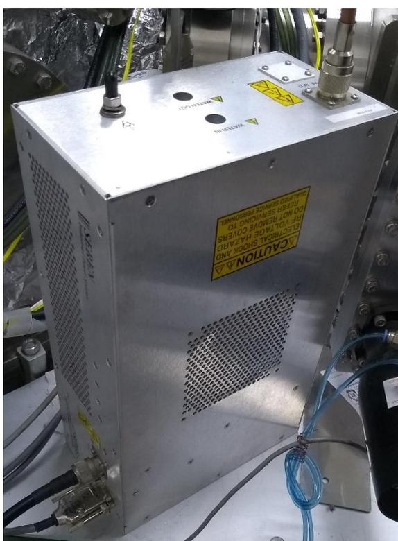
Figura 67 – Casador de Impedância AT-3
