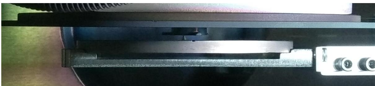
Figura 124 – Porta-amostra desalinhado, forçando o garfo.
