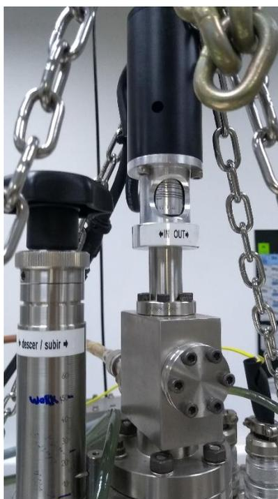
Figura 118 – Ajuste da altura do porta-amostra e eixo do motor
