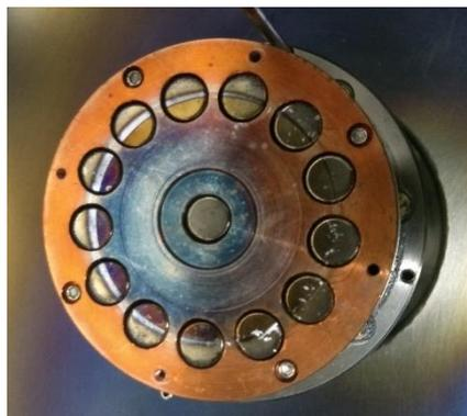
Figura 49 – disposição dos ímãs do magnetron, e a marca deixada no cobre por excesso de calor devido à refrigeração insuficiente.
