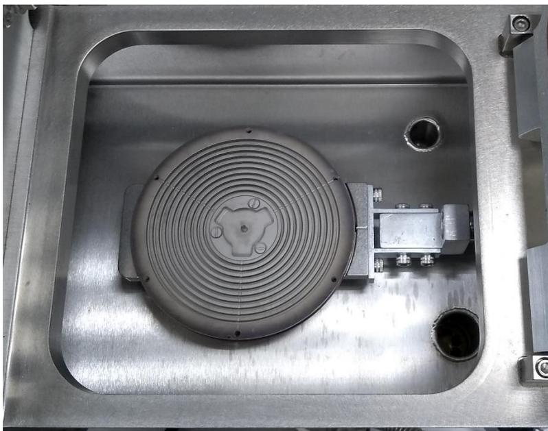
Figura 117 – Posição de encaixe do porta-amostra sobre o garfo.
