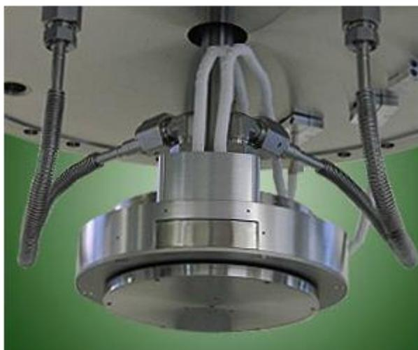
Figura 44 – Aquecedor do porta-amostra SHQ400.
