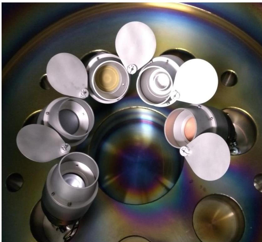
Figura 46 – Os magnetrons no interior da câmara de vácuo com os obturadores abertos mostrando os alvos.
