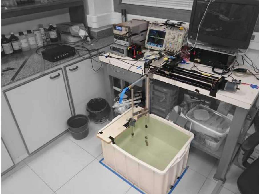
Figura 6.1.1.: Aparato experimental, montado no Laboratório de Instrumentação e Medidas do CBPF, utilizado para medir a velocidade do som na água.
