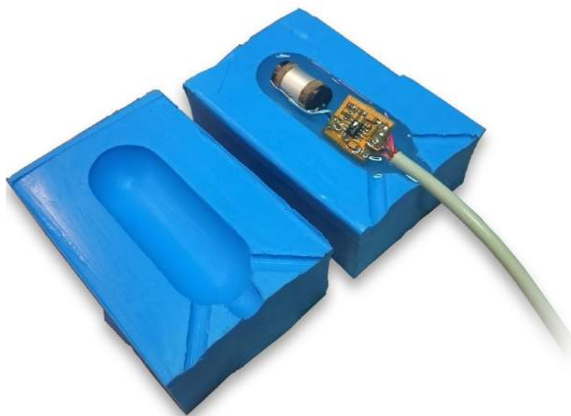
Figura 5.1.2.: Resinagem da primeira metade do sensor termoacústico. Destaca-se o molde bipartido em borracha de silicone de cor azul.
