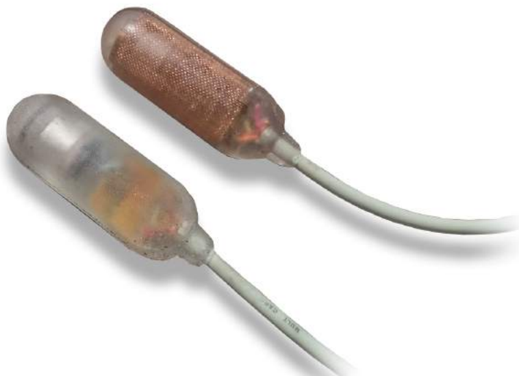
Figura 5.1.3.: Resultado final da montagem de dois sensores. No sensor superior foi adicionada uma malha de blindagem feita de cobre.
