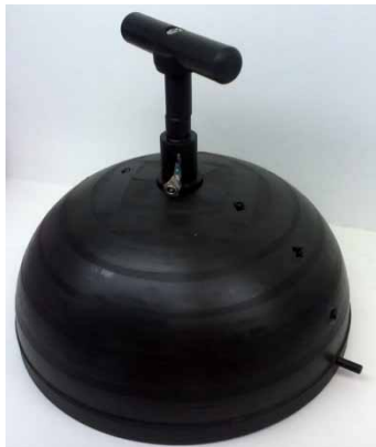
Figura 4.9: Dispositivo para instalação do LED.
