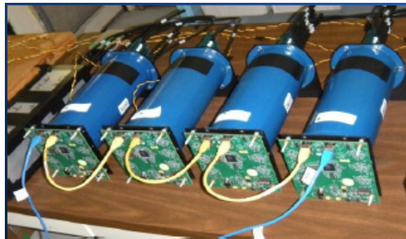
Figura 3.23: Montagem de teste das MAPMT.
