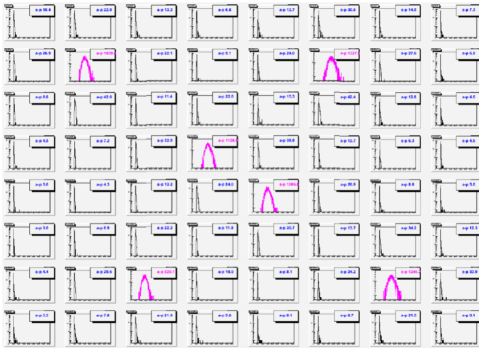
Figura A.5: Distribuições de contagem em teste de diafonia. Apenas os elementos 10, 14, 28, 51 e 55 estão iluminados. O elemento 37 apresenta sinal indicando diafonia entre ele e o seu vizinho 28.
