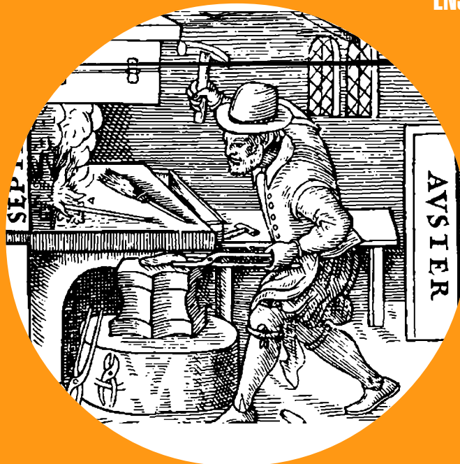
Ilustração do De magnete mostrando como magnetizar uma barra de ferro martelando-a, enquanto ela é mantida alinhada na direção norte-sul
