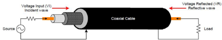
Figura 3-4 – Ilustração de cabo coaxial transmitindo o sinal da fonte à carga. O sistema deve estar casado para evitar reflexões.
