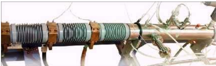
Figura 1-1 – Protótipo de cabo supercondutor desenvolvido em laboratório.
