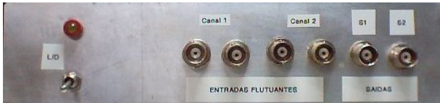
Figura 3-7 - Ilustração do Módulo onde foi instalado o amplificador.
