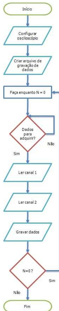
Figura 3.7 - Fluxograma do programa de aquisição de dados.
