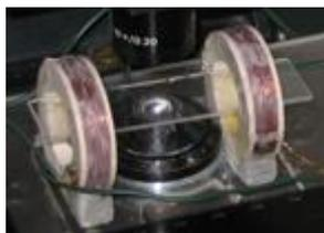
Figura 3.4 – Par de bobinas geradoras de campo magnético.
