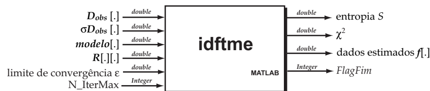
Figura 4.1: Diagrama da função idftme construída no MATLAB, com os parâmetros de entrada [ DObs , SigDObs , modelo , R , LimConv , NIterMax ] e os respectivos parâmetros de saída [ S , \chi^2 , f , FlagFim ].
