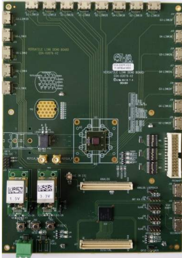
Figura 9.4: Vista superior da placa VLDB.
