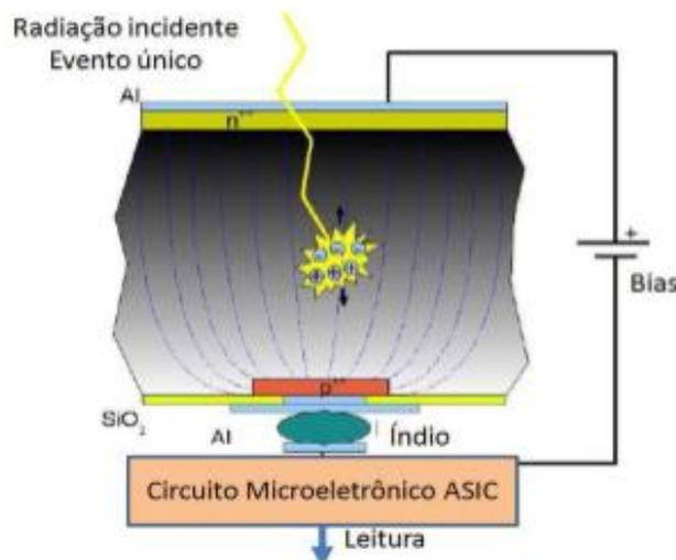
**Figura 1.16:** Diagrama simplificado de um pixel em um Detector “Pixelado” [21].
