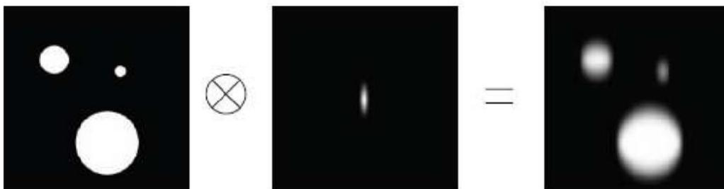
**Figura 2.6:** Uma imagem embaçada é a convolução entre a imagem nítida original e a PSF. Fonte: [10].
