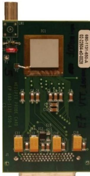
**Figura 2.5:** Placa Medipix Probe Card do CERN com um chip Timepix montado.
