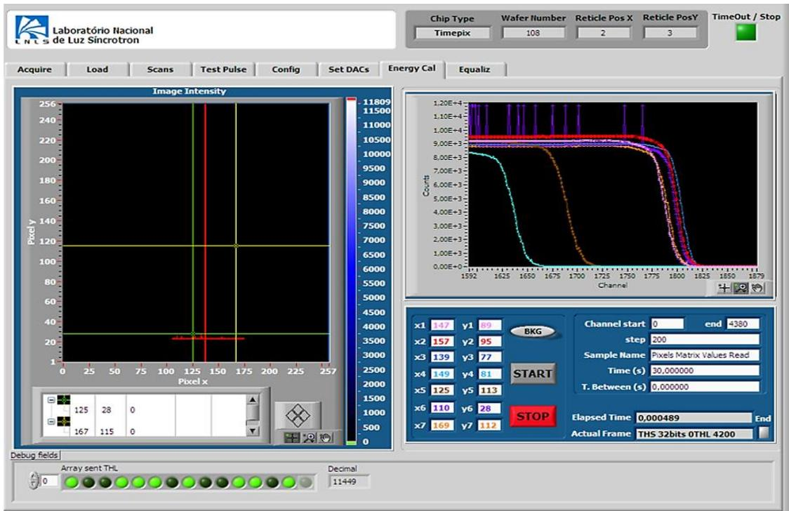
“Energy Cal” – Tela para configurar e realizar o procedimento de calibração em energia do detector. Esquerda: imagem da matriz de pixels 256x256 de cada passo do processo. Direita: gráfico da relação entre a energia da fonte e o DAC “Threshold THL”. Abaixo à direita: parâmetros e comandos para a calibração em energia, podendo seleccionar até oito pixels para a varredura.
