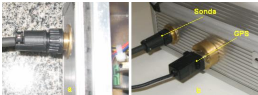
Figura 22 – A conexão da sonda com o Caipora no conector SDI-12, este conector está ligado fisicamente ao módulo SDI-12.
