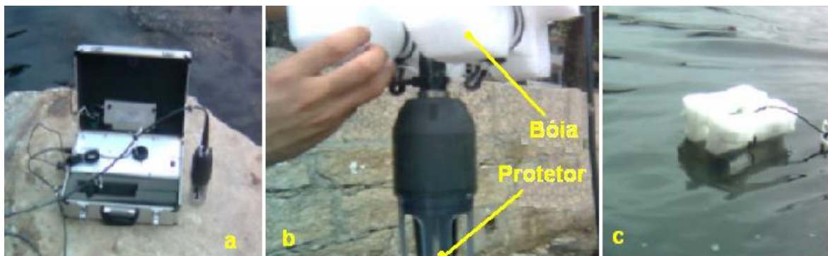
Figura 33 – Preparando o Caipora para testes de verificação de funcionalidade do sistema, em uma margem da enseada de Botafogo.
