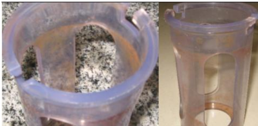
Figura 51 – No período de medição na CMB aconteceu a deposição de algumas substâncias químicas sobre o protetor da sonda. Não é conhecida a composição da substância e nem os efeitos que ela pode causar no equipamento. O período que se deu a acumulação da substância sobre o as partes da sonda foi de 1 semana.
