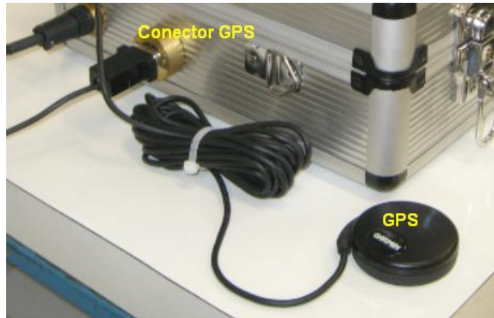
Figura 7 – O dispositivo de posicionamento global conectado ao corpo do Caipora que informa ao sistema posição, data e hora.
