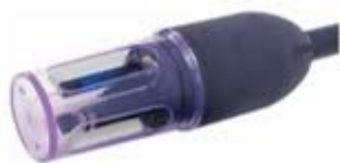
Figura 14 – Sonda multiparâmetros modelo Quanta da Hydrolab, com sensores de temperatura, pH, condutividade e ORP.
