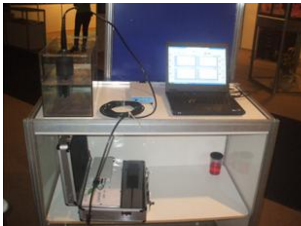
Figura 4 – Sistema medindo em ambiente aquático, a sonda está inserida em um aquário, enviando os dados dos parâmetros desse meio para o dispositivo, que então gera os gráficos num terminal de microcomputador que está acoplado ao Caipora por um link de rádio.
