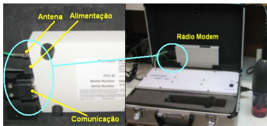
Figura 21 – Corpo do sistema Caipora, a vista da estrutura interna que mostra a localização do radio modem, à direita (b), e as conexões para o funcionamento do mesmo, à esquerda (a).
