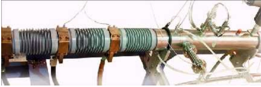
Figura 1- Protótipo de cabo supercondutor desenvolvido em laboratório.
