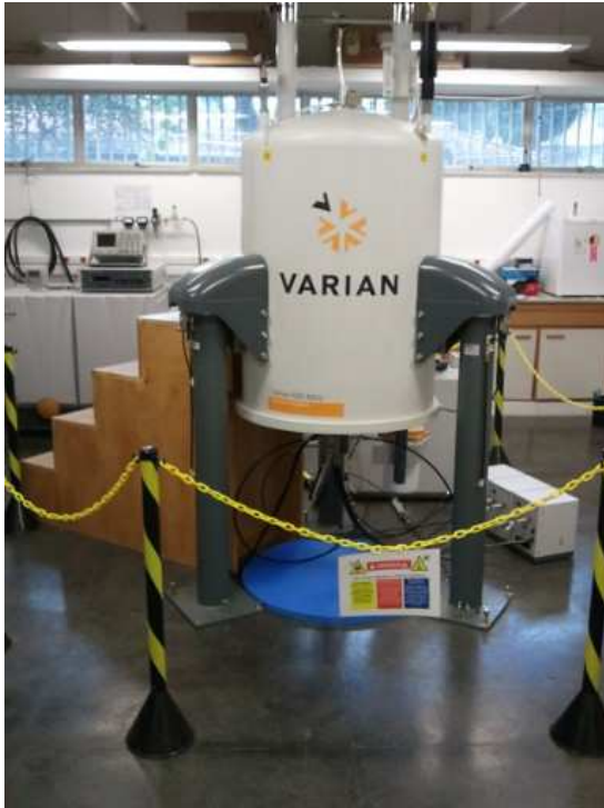
Figura 2.6: (a) Espectrômetro do Laboratório de RMN do CBPF. (b) O painel de controle contém informações sobre o experimento em andamento, inclusive a temperatura da amostra, medida por um termômetro embutido no espectrômetro, em graus Celsius (no mostrador digital, em vermelho).
