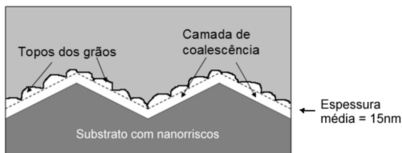
Figura 4.26: Esquema idealizado de um filme fino de permalloy, com 15 nm de espessura, com grãos semielipsoidais coalescentes, exibindo a camada contínua de material que se forma por baixo dos topos dos grãos.
