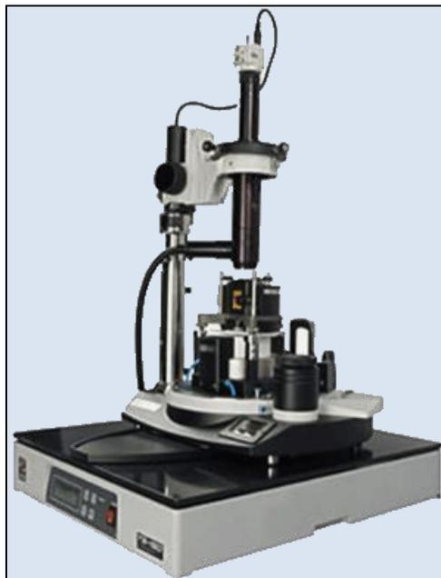
**Fig. 3.8-4:** Foto do SPM modelo NTEGRA utilizado para as medidas com AFM.
