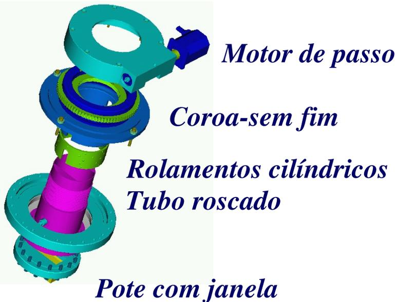
A peça central do FPD consiste de um tubo cilíndrico rosqueado que move-se na direção do eixo pela ação de um sistema de coroa e sem-fim atuados por um motor de passo.
