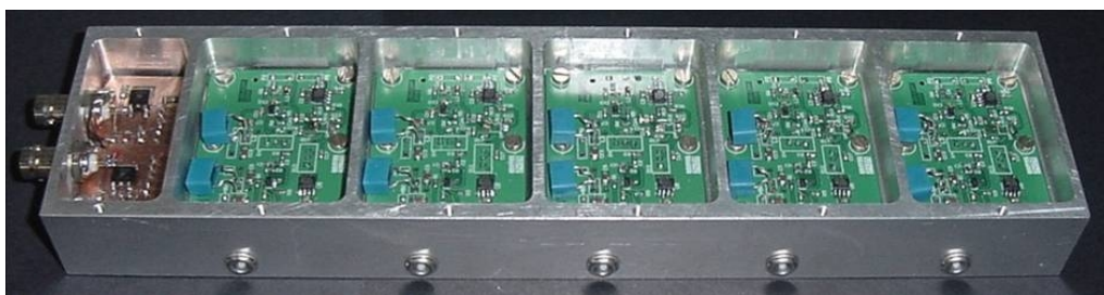
Figura 4.7: Módulo eletrônico de front-end com 5 canais.
