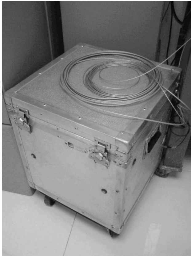
Figura 6.16: Câmara escura para testes com o PMT.
