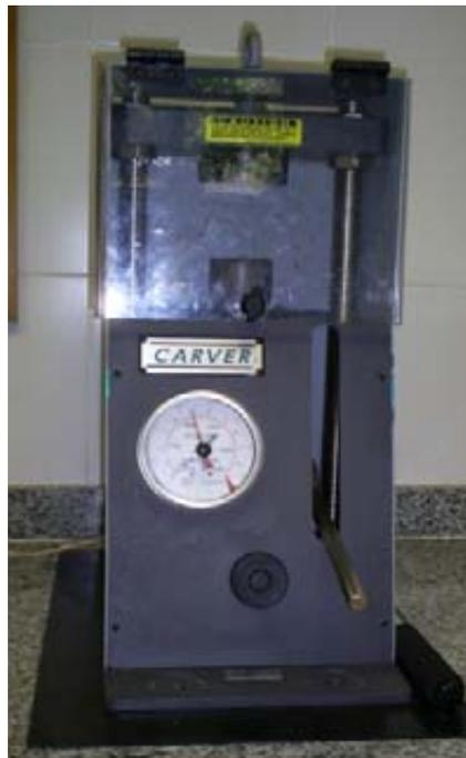
Figura 6: Prensa da marca CAVER usada para pastilhar a mistura dos pós dos precursores de YBCO.
