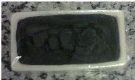
Figura 3: Pó obtido após o primeiro tratamento térmico.
