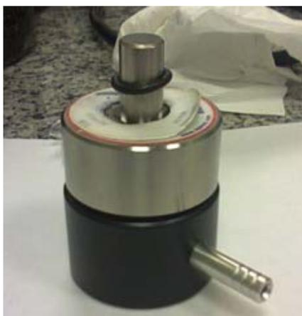
Figura 5: Matriz pastilhadora usada para prensar e dar forma ao pó dos precursores de YBCO.
