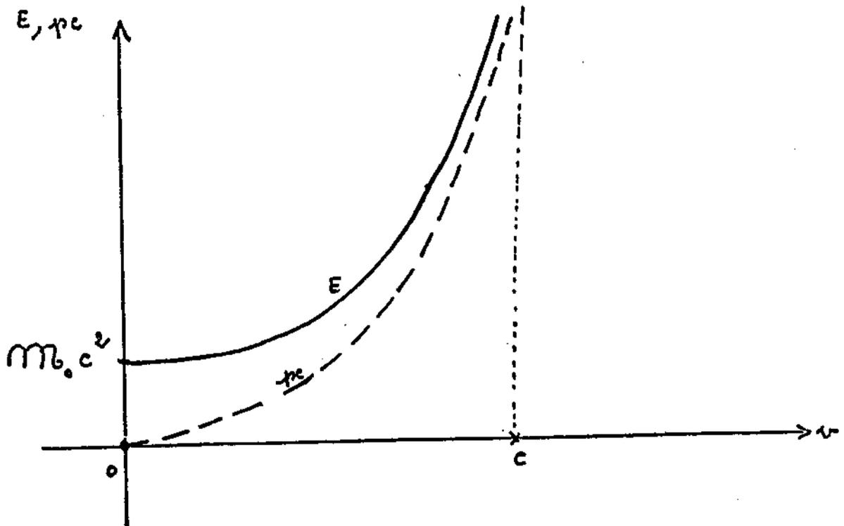
FIGURE (2, 2) - Énergie et impulsion d'une particule en fonction de la vitesse
