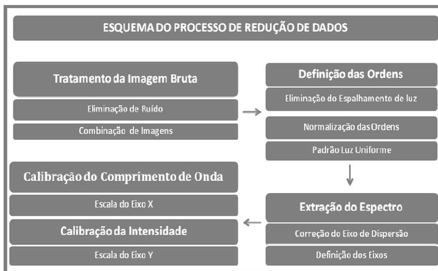
**Figura 4.1** – Esquema simplificado do Processo de Redução de Imagem.
