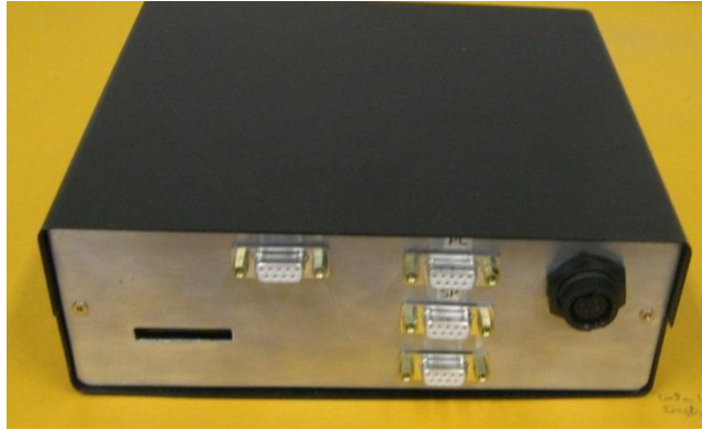
Figura 8: Dispositivo embarcado montado e pronto para a conexão dos sensores. Esta versão possui uma conexão serial para comunicação com o Software Supervisor, outra para a comunicação com o Sensor serial embarcado, além de uma conexão SDI-12 e entrada para cartão SD. Outros dois conectores DB9 foram incluídos ao chassi para possíveis inclusões de módulos.
