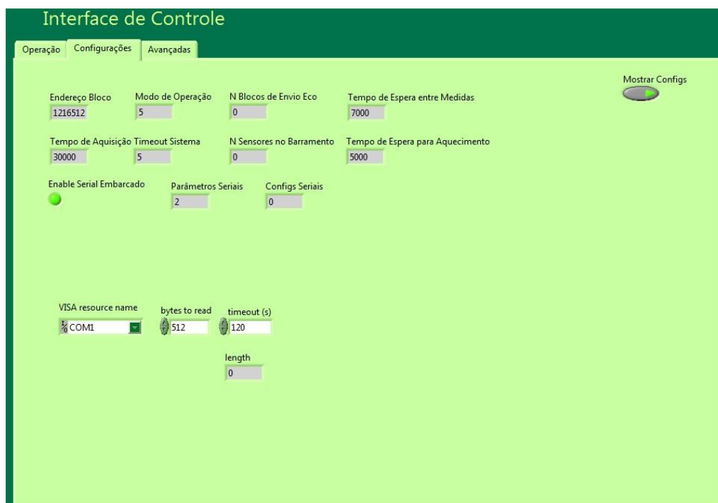
Figura 29: Aba de configurações da Interface de Controle. Através dessa interface é possível realizar algumas configurações básicas no sistema, assim como monitorar o status atual das suas configurações.
