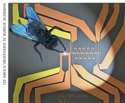
Possível esquema de um chip atômico. O ponto luminoso é um condensado de Bose-Einstein, mantido por campos magnéticos a uma distância de alguns microns da superfície do circuito integrado – a mosca dá uma idéia do grau de miniaturização
