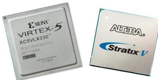
Figura 3-1 – Chips FPGA modelos Virtex-5 e Stratix V respectivamente dos fabricantes Xilinx e Altera Corporation
