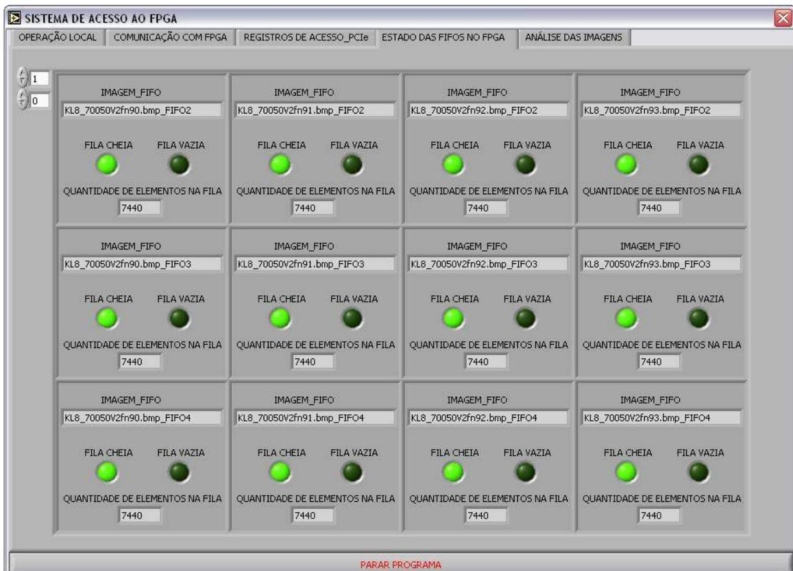
**Figura 5-2 – Verificação dos status e da quantidade de elementos para as FIFOs embarcadas no FPGA após a transmissão das imagens.**
