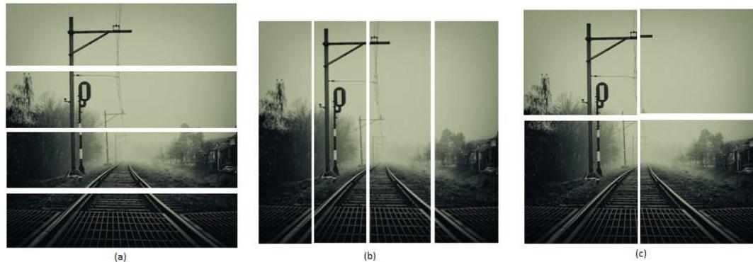
**Figura 2-7 – Divisão das imagens para aplicação de paralelismo de dados nos algoritmos de processamento. Cada processador fica responsável por aplicar operações em cada um dos blocos que compõem a imagem. (a) Divisão em linhas. (b) Divisão em colunas. (c) Divisão em blocos retangulares**
