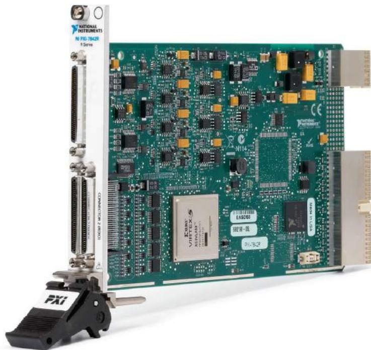
**Figura 1-2 – Módulo PXI 7842R da *National Instruments* para instrumentação modular. O módulo possui um FPGA do fabricante *Xilinx*, modelo *Virtex-5 LX50*, para personalização de projetos em *hardware*.**
