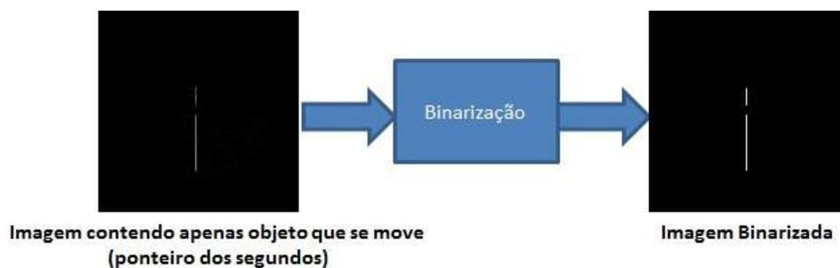
**Figura 2-15 – Segmentação através da técnica de *Thresholding* (Binarização por limiarização). Objeto que se movimentava (ponteiro dos segundos) foi realçado a fim de facilitar sua detecção pelos algoritmos de reconhecimento de padrões que compõem as etapas mais complexas de um algoritmo de processamento de imagens.**
