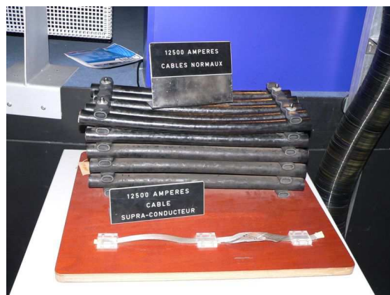
Figura 1.1: Cabos normais em uso no LEP (acima) e supercondutores, do LHC (abaixo)
