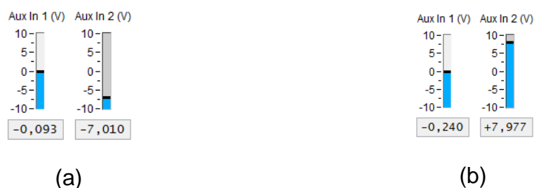
Figura 87: Níveis das entradas auxiliares no ponto inicial e final de uma varredura de pitch . [Fonte: autor]
