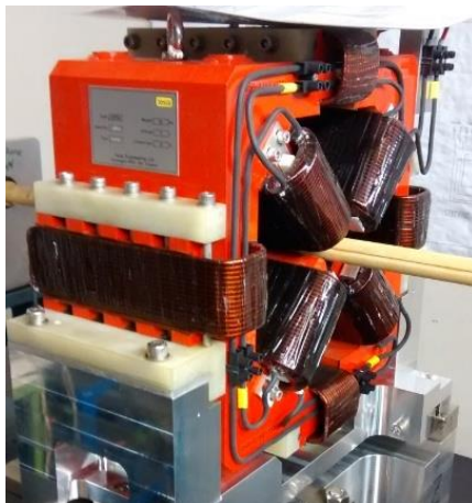
Figura 5: Quadrupolo em bancada de caracterização magnética pela técnica da bobina girante no PSI (Paul Scherrer Institute, Villigen, Suíça). [Fonte: autor]
