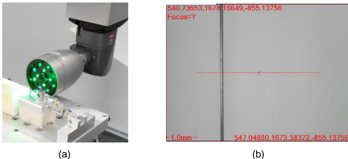
Figura 53: (a) Módulo de visão da MMC multissensor Global Performance Silver Edition 12.30.10 da Brown & Sharpe Hexagon Metrology ; (b) Imagem do fio no software PC-DMIS. [Fonte: autor]
