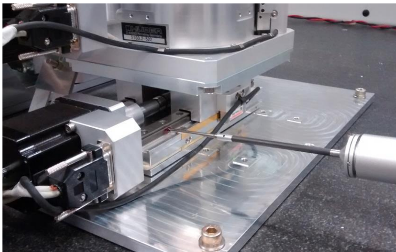
Figura 30: Procedimento de ajuste de paralelismo entre os estágios horizontais na MMC. Os estágios estão fixados à chapa de adaptação à mesa de granito da MMC. [Fonte: autor]
