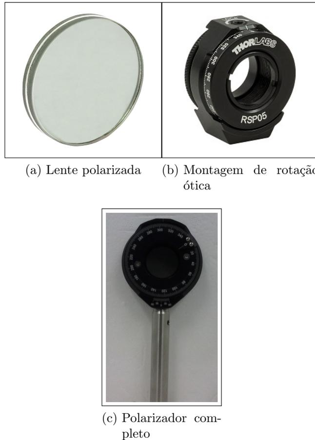
Figura 4.4 – Polarizador ótico linear completo.
