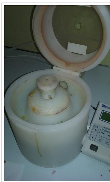
Figura 3.5 – Equipamento utilizado na técnica de *Spinner* da Laurell Technologies Corporation para o processo de deposição dos filmes de PANi.
