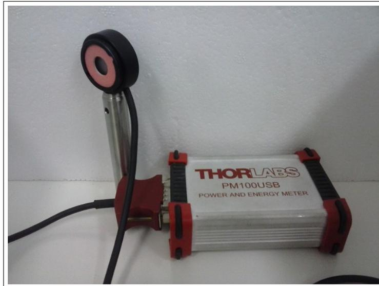
Figura 4.5 – Detector PM100USB da Thorlabs.
