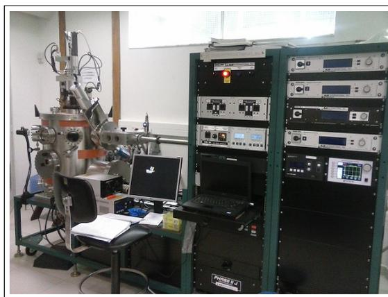
Figura 3.2 – Equipamento de *Sputtering* utilizado para o processo de deposição dos filmes de Ouro e Platina.
