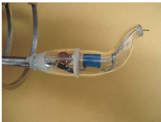
Figura 11.1: Sonda de Langmuir com circuito passa-baixa.
