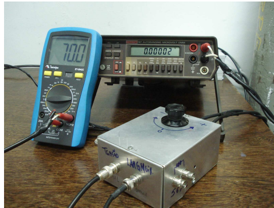
Figura 11.4: Medidores de Tensão e Corrente e Fonte variável de -70 a 70 volts para medidas de sonda de Langmuir.
