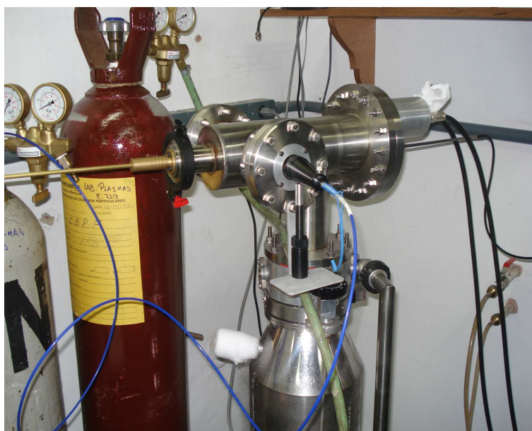
Figura 11.8: Lente Coletora em Frente a Janela do Reator.
