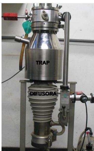
Figura 8.4: Bomba Difusora e Trap.
