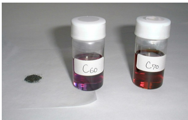
Figura 7. Foto com soluções de C_{60} e de C_{70} . O pó escuro à esquerda é um pó de fullereno (KYUSHU, 2006).
