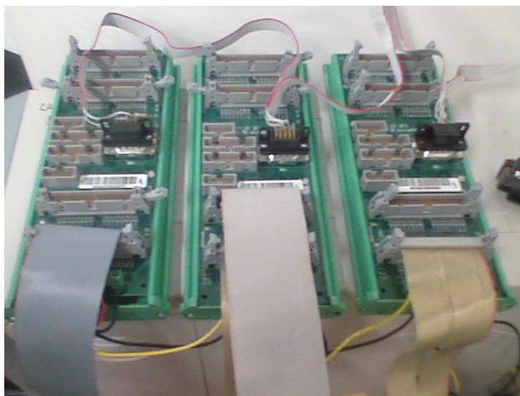
Figura 55 - Rede de três ELMBs em topologia em barra
