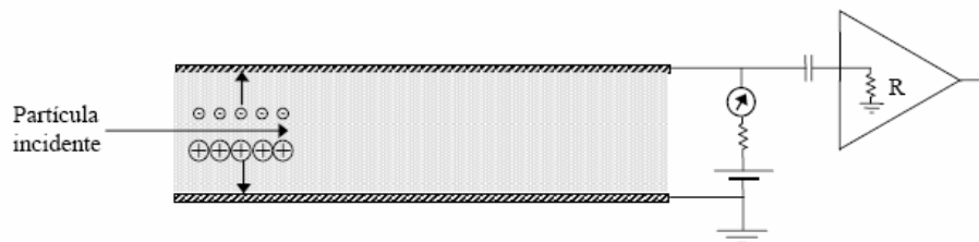
Figura 5 - Esquema de funcionamento de um detector a gás
