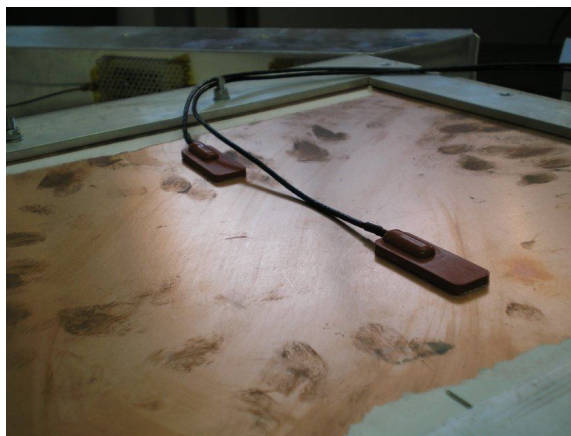
Figura 61 – Fixação de 2 sensores
