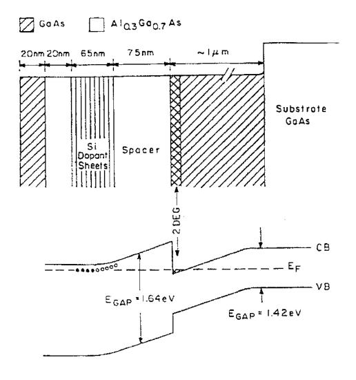
Figura 1.3: Camadas em uma heteroestrutura GaAs-AlGaAs. A parte superior do diagrama mostra a disposição espacial das camadas na amostra. A parte inferior mostra a estrutura correspondente dos níveis de energia. A região indicada por 2DEG é a do gás bidimensional de elétrons, e  $E_F$  denota a energia de Fermi [15, 19].
