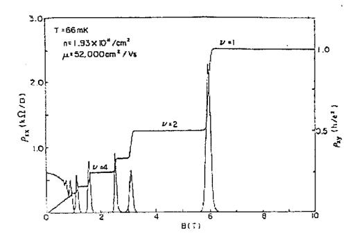
Figura 1.5: Resistividades longitudinal  $\rho_{xx}$  e transversal  $\rho_{xy}$  em função da intensidade do campo magnético B, mostrando a ocorrência dos plateaux de  $\rho_{xy}$ , característicos do Efeito Hall Quântico Inteiro para alguns valores do fator de preenchimento  $\nu$ , numa amostra de GaAs-AlGaAs com baixa mobilidade  $\mu=5.2\times 10^4~cm^2/Vs$ , densidade eletronica  $n=1.93\times 10^{11}/cm^2$ , e à temperatura T=66~mK. [22].
