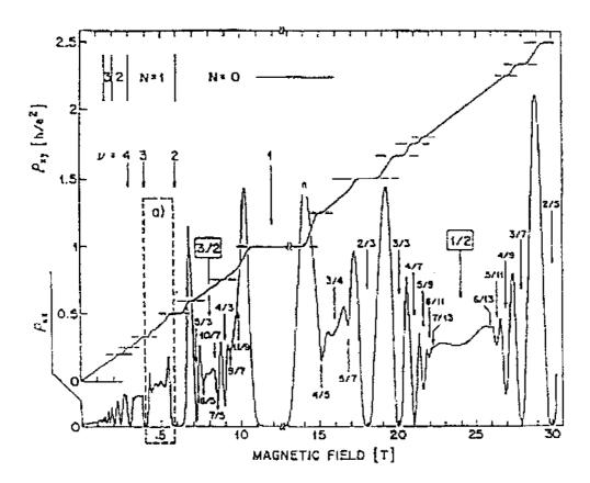
Figura 1.6: Resistividades longitudinal  $\rho_{xx}$  e transversal  $\rho_{xy}$  em função da intensidade do campo magnético B, mostrando a ocorrência dos plateaux de  $\rho_{xy}$  característicos dos Efeitos Hall Quântico Inteiro e Fracionário, em uma amostra de GaAs-AlGaAs com alta mobilidade eletrônica  $1.3 \times 10^6~cm^2/Vs$ , densidade  $3 \times 10^{11}~cm^{-2}$  e temperatura T=85~mK [22].
