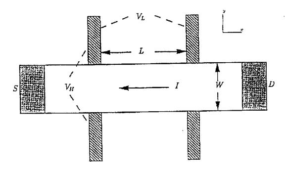
Figura 1.4: Geometria de um dispositivo para medição do Efeito Hall Quântico. A amostra propriamente dita corresponde à área retangular em branco, com largura W; as partes hachuradas correspondem aos terminais externos. Uma diferença de potencial aplicada aos terminais S e D gera uma corrente I. Selecionando-se pares de terminais apropriados, pode-se medir a d.d.p. longitudinal  $V_L$  (ao longo de do comprimento L) e a d.d.p. transversal  $V_H$  (voltagem Hall). [15]
