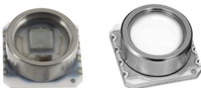
Figura 1: Foto do sensor MS5803-01. No sensor da esquerda é possível observar o elemento piezoelétrico, pois não foi adicionada a segunda camada de gel KE1052 com carga de  $TiO_2$ , de cor branca.
