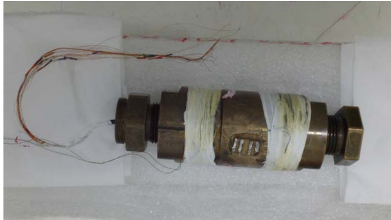
Fig. 3.5.1. Fotografia da célula de pressão líquida utilizada no presente trabalho.
