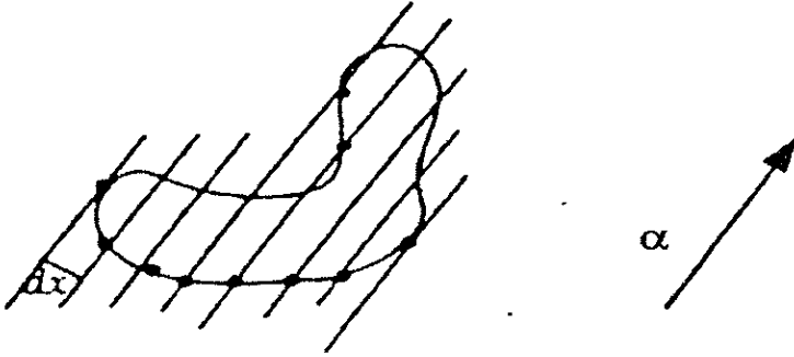
Figura B.1: Determinação do número de intercepções N_\alpha a uma dada direção \alpha .
